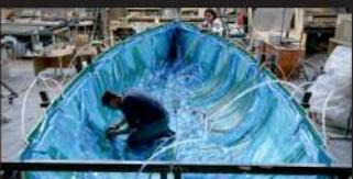
Яхты mX700 изготавливаются из стеклопластиковой сэндвич-конструкции на основе эпоксивинилэфирной смолы, мультиаксиальной ткани и пенопласта в качестве наполнителя. Для достижения лучшего качества материала корпуса применен метод инфузионного вакумного формования. Эта уникальная для отечественного яхтостроения технология, в сочетании с использованием углеродистых материалов в особо ответственных местах, позволила существенно повысить качество и технические характеристики корпуса.
